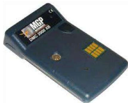
El dosímetro es un equipo fundamental en todas las fases de la Intervención, pero en este caso se utiliza como un equipo de *rápida detección en primera respuesta* utilizándolo como un medio ligero, fácil de manejar y fiable que puede darne una idea clara de si estoy en presencia de radiación y si los niveles son altos, simplemente
