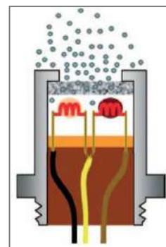
Los llamados pellistores son perlas cerámicas minúsculas y muy porosas (diámetro aprox. 1 mm) rodeando una pequeña bobina de hilo de platino. Hay una corriente eléctrica fluyendo a través de la bobina de platino de tal manera que el pellistor se calienta a unos cientos de grados Celsius.
