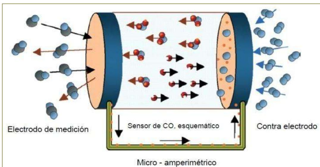
Cuentan normalmente con un electrodo de trabajo (que detecta), un contra electrodo y generalmente otro electrodo de referencia. Estos se encuentran dentro de la carcasa del sensor y en contacto con un líquido electrolítico. El electrodo de trabajo está en la cara interna de una membrana de teflón que es porosa al gas, pero impermeable al líquido electrolítico.
