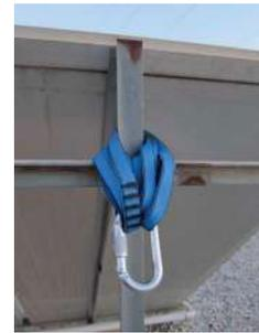
Las cintas y anillos de cuerda: Son bandas largas, estrechas y planas, de estructura textil, destinadas a soportar fuerzas (no a absorber energía (no sirven para caídas)).
