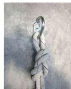
Anclajes de clase B: Son dispositivos de anclaje provisional transportable, los cuales fijaremos de forma temporal a un soporte. Deben tener marcado CE y pueden ser de tipo cinta, metálico y de cuerda.
