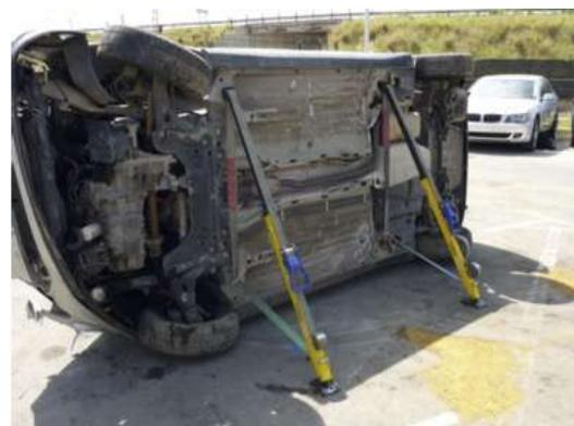
Colocar protección del Stab-Fast en zonas calientes
