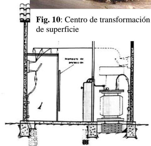
**Fig. 11:** Partes de un centro de transformación.
