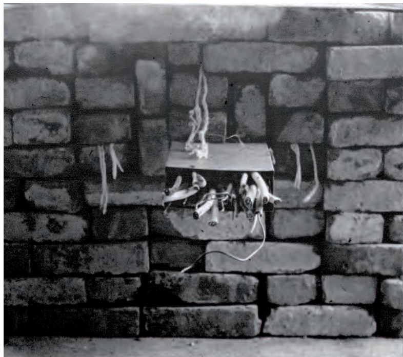
Estructura de prueba del primer aislamiento de cables de OBO
