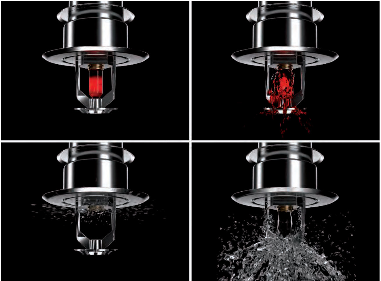
Activación de un cabezal rociador, o sprinkler, al sobrepasarse la temperatura nominal de 68 C° en la ampolla de vidrio.
