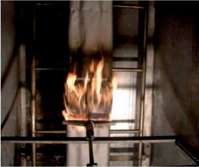
Prueba de la cinta de cables
