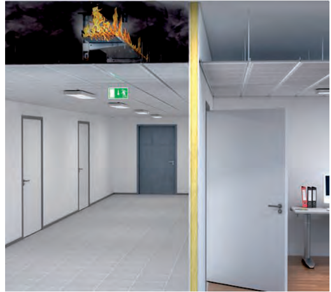
Techo F 30 con incendio desde arriba
