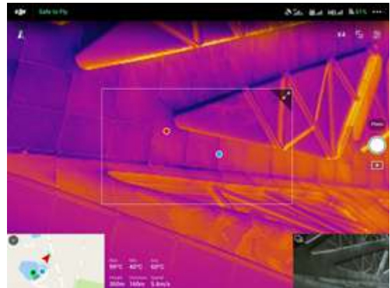
Modelo radiométrico donde el usuario puede pulsar en cualquier pixel para obtener una medición precisa de la temperatura o seleccionar un área para saber la temperatura media, máxima y mínima en el área seleccionada.
