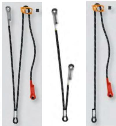
**Elemento de amarre**, este material es parte del sistema de protección contra caídas, una vez instalado en el arnés, su función es conectarse con un punto fijo de anclaje u otro dispositivo, a este equipo también se le llama cabo de anclaje, como principales características deben tener una resistencia igual o superior a 22 KN.
