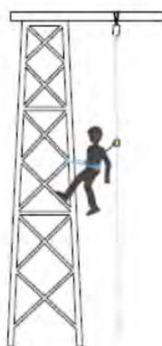
**Sujeción**, un sistema de sujeción, como su propio nombre indica, sujeta al usuario y le permite posicionarse con precisión en apoyo o en suspensión. Este sistema tampoco se ha diseñado para detener caídas. El trabajador debe estar en tensión sobre su sistema de sujeción. Debe ser completado con un sistema anti caídas.
