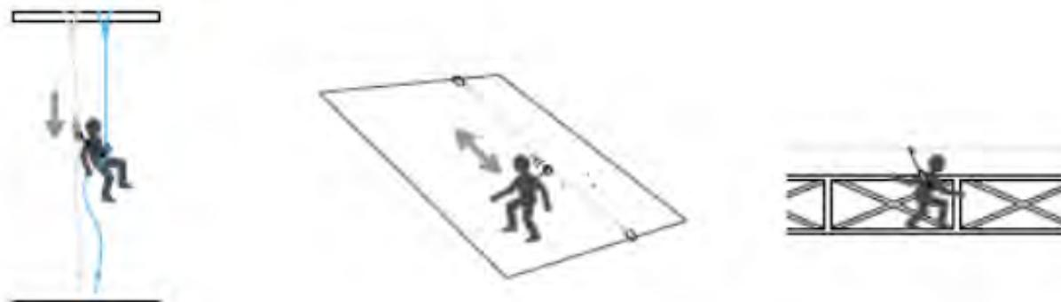
**Anticaídas**, un sistema anti caídas es un dispositivo de aseguramiento, independiente del modo de progresión o sujeción, conectado al punto de enganche “A” (anti caídas) del arnés. No impide la caída libre, su función es **detenerla**, limitando la fuerza de choque soportada por el usuario. Al utilizarlo, siempre se debe prever una altura que permita la caída libre: altura libre de seguridad.
