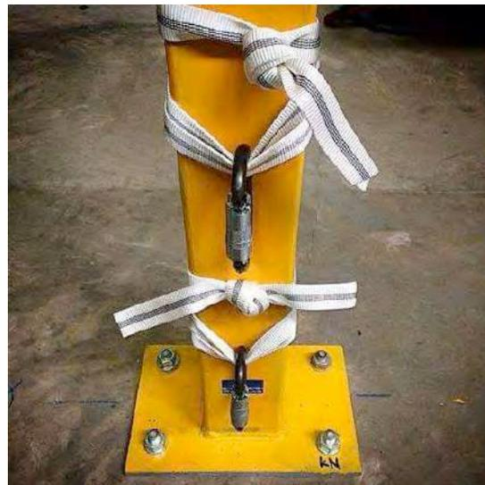
Definiremos Anclaje a la instalación de los diferentes elementos de sujeción conformados por Cintas, Cuerda y Mosquetones en un Punto Fijo, los cuales en conjunto están destinados a proporcionar un sitio confiable, capaz de servirnos de soporte de cargas de trabajo, seguridad en los Trabajos Verticales. Existe dos tipos de anclajes:
