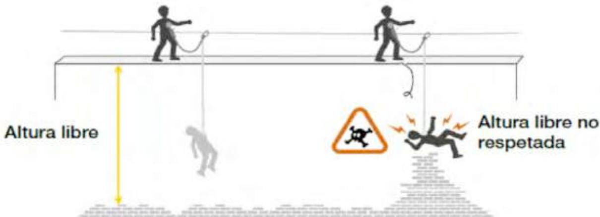
El factor de caída es el que determina la dureza o gravedad de una caída y este dice que: **A MAYOR VALOR, MAYOR GRAVEDAD**. Su valor, que en condiciones normales estará comprendido entre 0 y 2, se calcula dividiendo la altura de la caída entre la longitud de cuerda o sistema amarre utilizada para su amortiguación.
