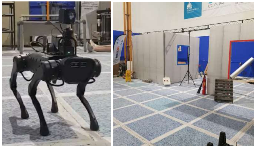
Figura 7: Robo Unitree A1 con la cámara térmica en campo para generación de datasets (izquierda). Ejemplos uno de los entornos de desastre reconstruido para generación de datasets (derecha). Fuente: Autor
