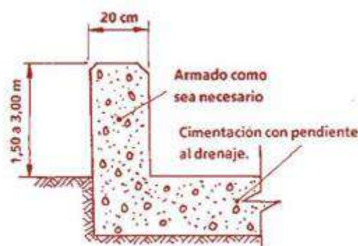
Ilustración 30 Esquema del muro exterior del cubeto
