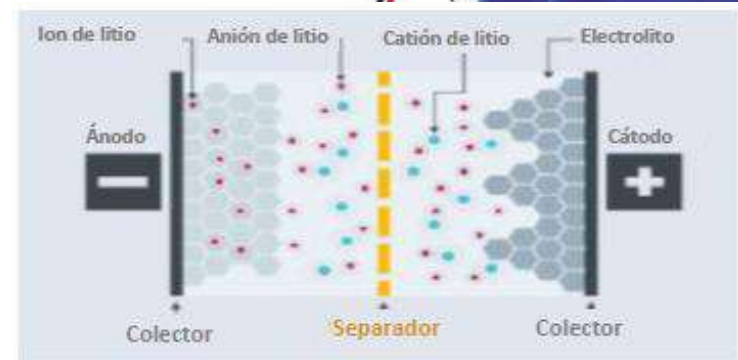
Figura 2: Estructura de las baterías de iones de litio
