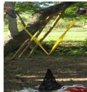
En cualquier sistema de reparto, los ángulos que forman los segmentos de cuerda que unen a los diferentes anclajes han de ser lo mas cerrados posibles e inferiores a los 60°. A medida que aumenta, el esfuerzo sobre los anclajes se multiplica.
