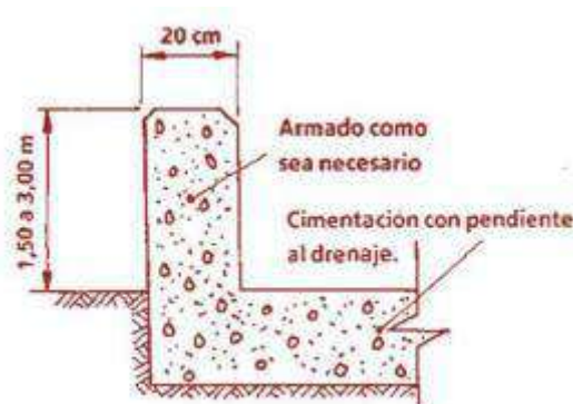
Ilustración 30 Esquema del muro exterior del cubeto
