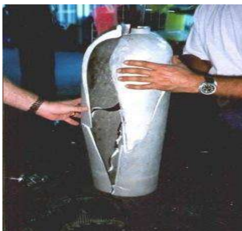
- Fig. 2.5.1.5 Fragmentos de un equipo de respiración autónomo, después de una explosión.
