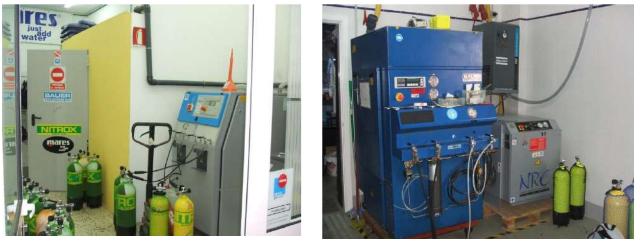
- Fig. 2.5.1.2 Imagen de dos centros de recarga, compresores y equipos de respiración autónomos.
