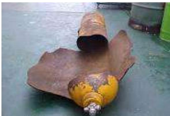
- Fig. 2.3.6.1.1 Rotura de un equipo de respiración autónomo.
