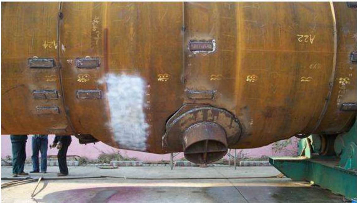
- Fig. 2.3.6.1 Rotura de un recipiente a presión durante una prueba de presión.
